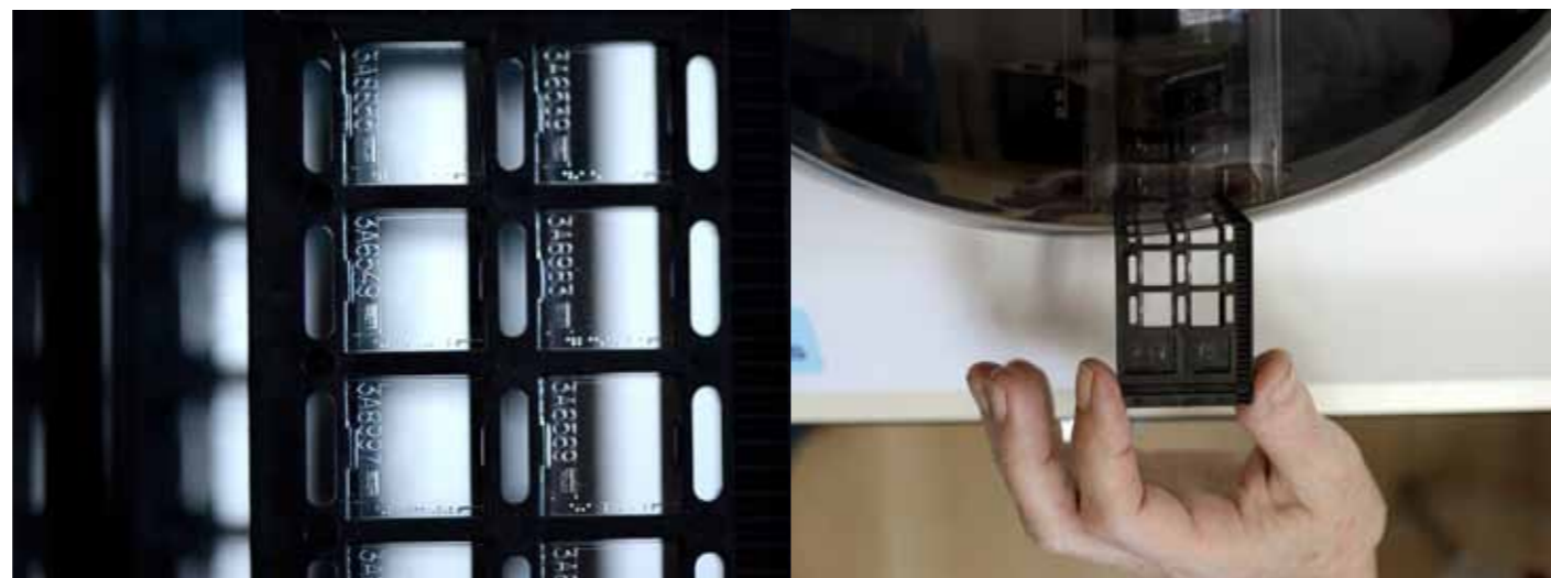
Детекторите за наличие на радон – 6-месечни (вляво) и едногодишни. Всеки съдържа чип, който се слага на слайд и се обработва химически.
