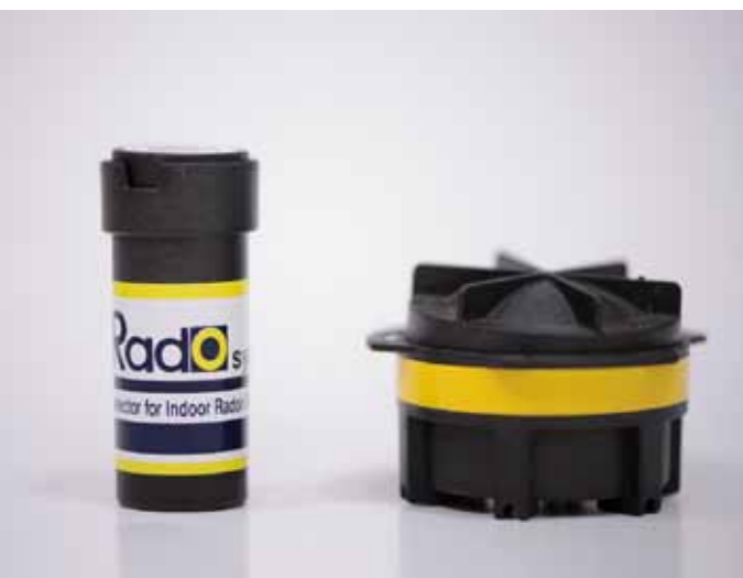
Детекторите за наличие на радон – 6-месечни (вляво) и едногодишни. Всеки съдържа чип, който се слага на слайд и се обработва химически.
