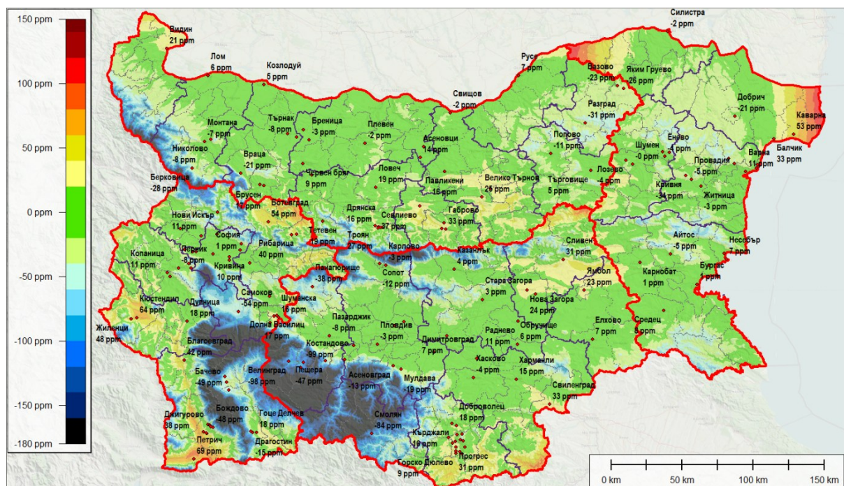
Фиг. 6. Комбинирана карта на деформациите при Вариант 2 (четири LDP зони)
