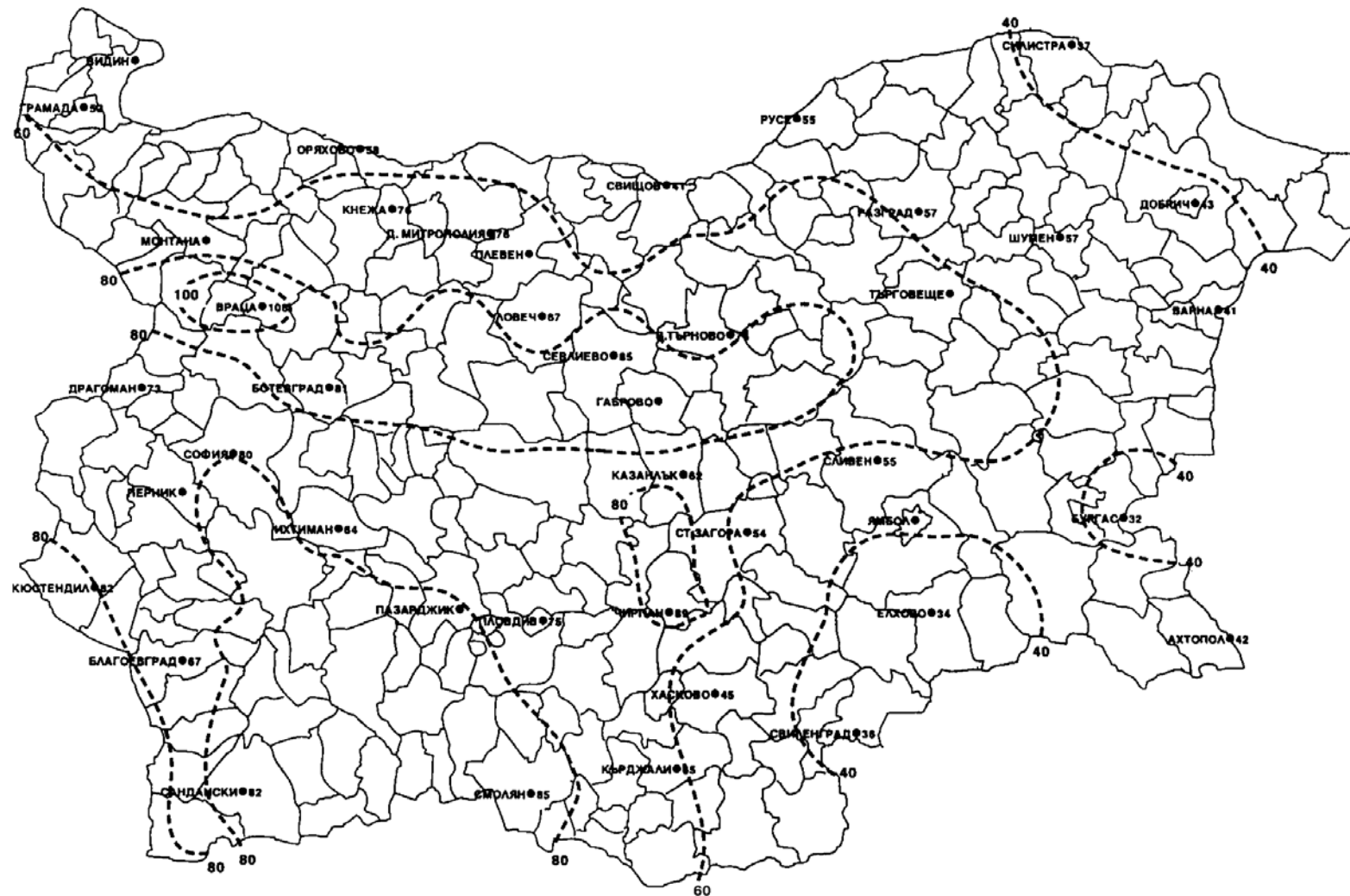
Карта за райониране на територията на страната в зависимост от интензивността на мълниеносната дейност в часове за година
